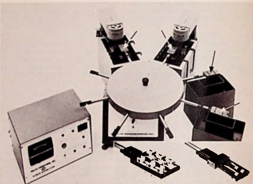
De roterende dompel-soldeerautomaat „Acculine\" van de firma Hollis is voorzien van „Vespe!\" polyimide houders van Du Pont.
